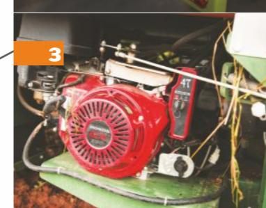
Двигатель внутреннего сгорания с электрическим стартером обеспечивает автономную работу упаковщика.
