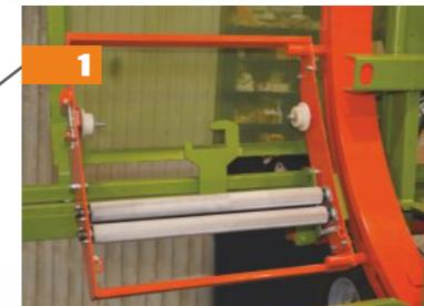
Каретка снабжена натяжным устройством для плотной обмотки рулонов.
