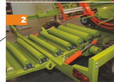
Наклонный механизм позволяет быстро переключать упаковщик в транспортное положение и обратно.
